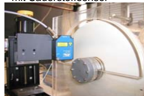
Abb. 2: Messung der Wasserfilmdicke
